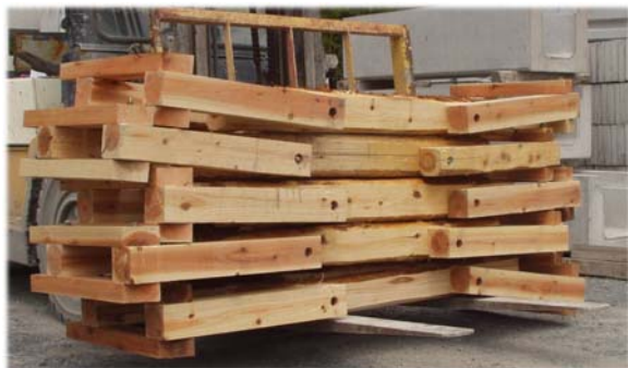
工場で組立てた後、平面状態にて出荷
